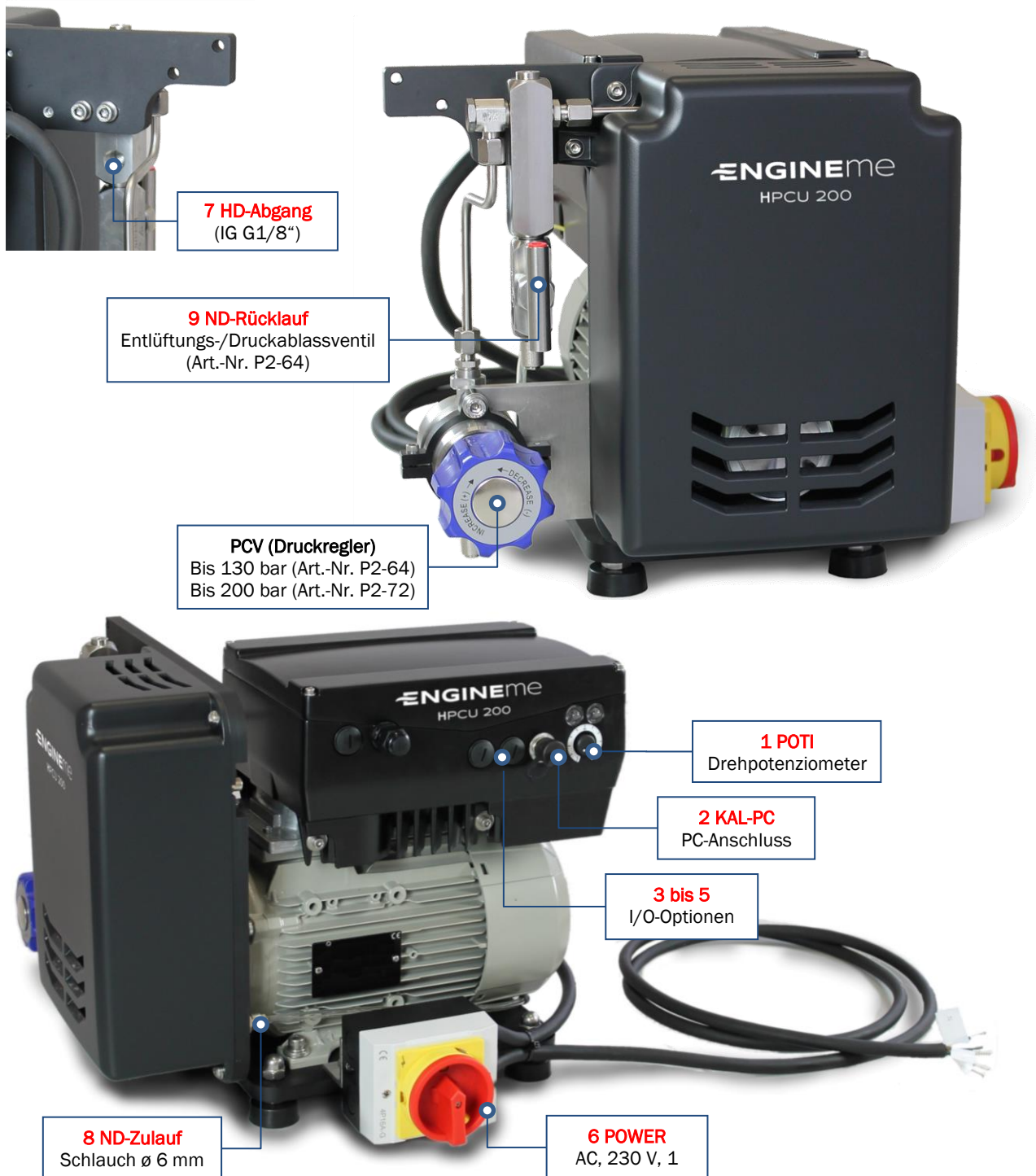
Abbildung 6 Ausführungsbeispiel HPCU 200 PCV + AV (mit Druckregler und Entlüftungsventil)
